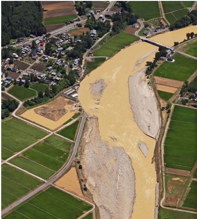
五十嵐川中流・田屋地区に発生した河岸浸食と洪水前後の比較 (株)パスコとグーグル社の写真を使用した
