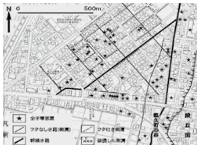
図 14 沖積低地に造成された住宅地の被害と水路・側溝の分布（久保田，2006）
