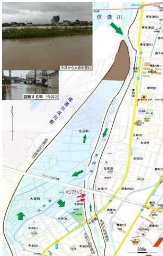
図 1 信濃川からの逆流と浄土川の溢流。添付写真は今井から浄土川(繁った草藪)をこえて大宮・田畑を冠水した溢流と今井町の道路を避難する車。
