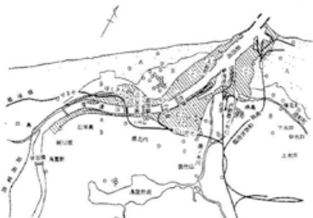
図4 新潟地震の被害分布 A：無被害地域 B：中位の被害地域． C：被害の顕著の地域
