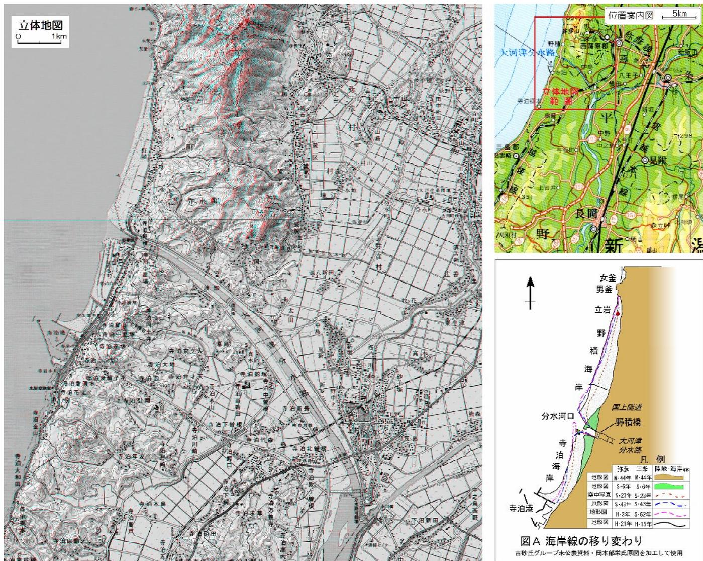
かつて、信濃川などの氾濫により越後平野はたびたび洪水に悩まされてきました。この被害をなくすため、信濃川の水の一部を海に流すように計画された水路が大河津分水路です。
